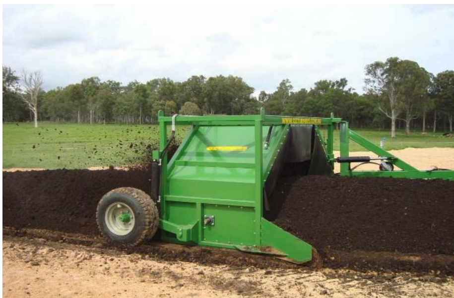
Slika 5. Otvoreni sustav kompostiranja
