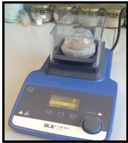
Slika 12. Mlin Tube Mill control IKA
