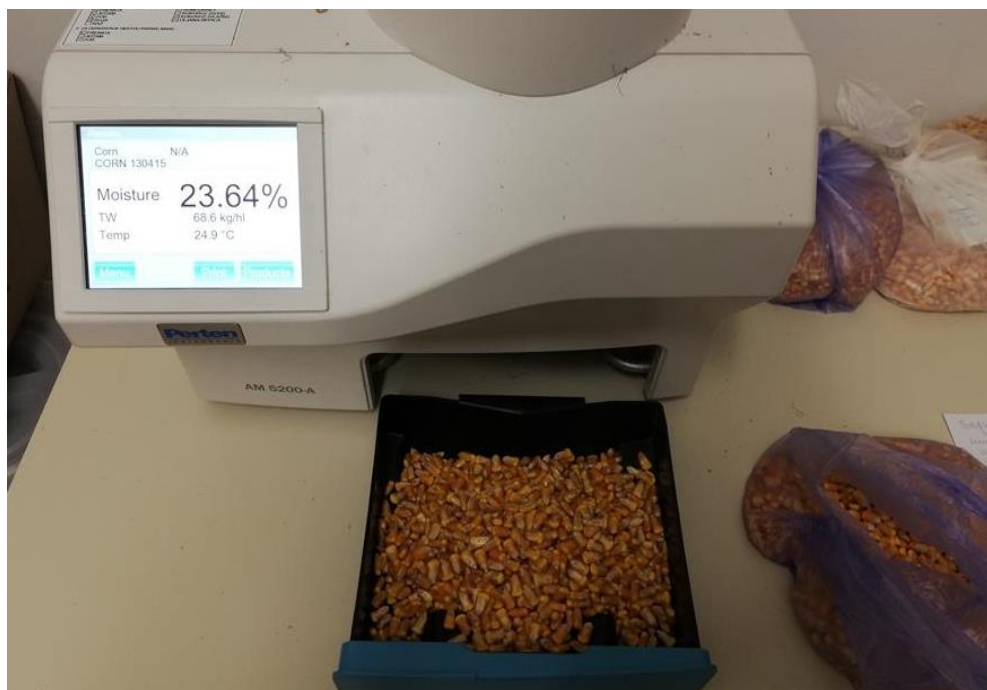
Slika 8. Mjerenje vlage i hektolitarske mase (izvor: Bižić, T.)
