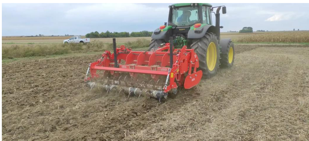
Slika 7. Predsjetvena priprema teškim podrivačem (Izvor: Antun Nikolić)
