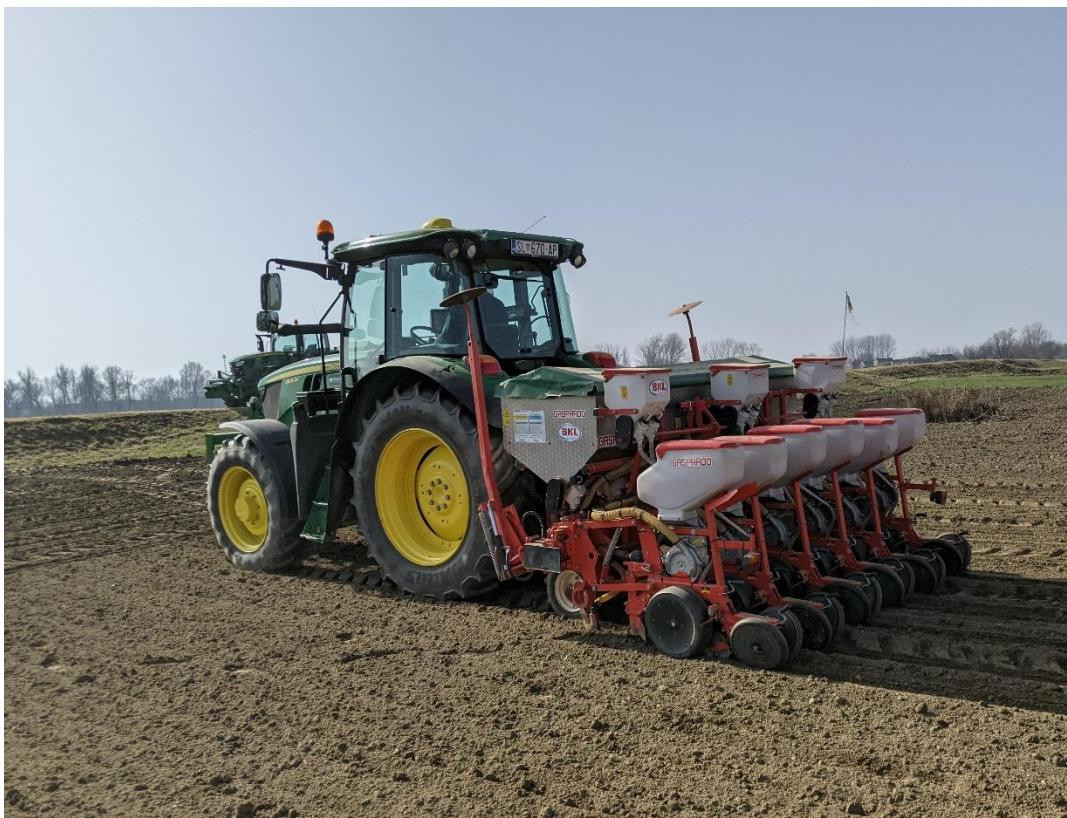
Slika 11. Sjetva varijante I šesterorednom pneumatskom sijačicom
