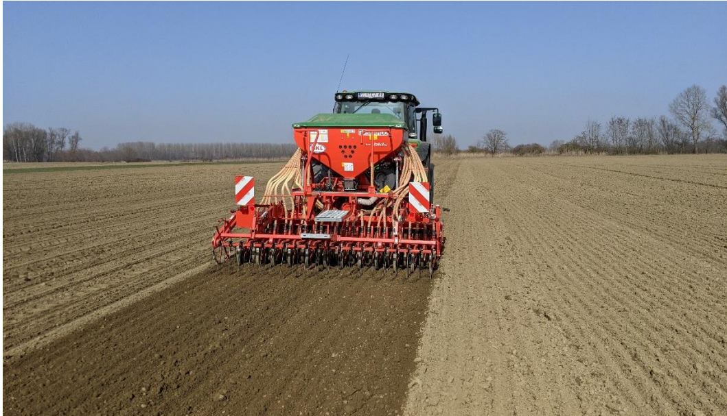
Slika 10. Sjetva varijante II i III pneumatsko žitnom sijačicom
