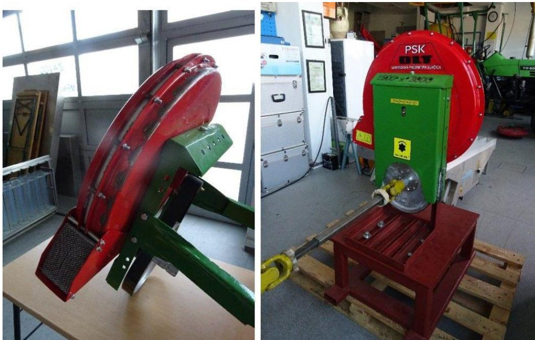
Slika 2. Radijalni ventilator sijačice PSK4
