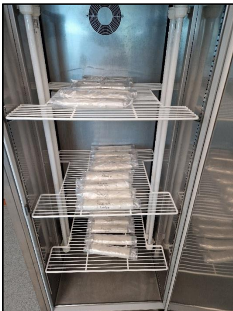
Slika 10. Test klijavosti sjemena u klima komori
