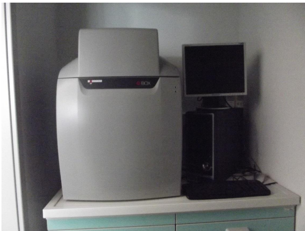
Slika 7. G:BOX uređaj za snimanje gela (foto original; J. Puškarić)
