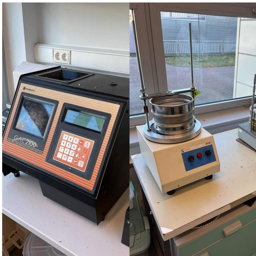
Slika 2. GAC 2100 i CISA uređaji korišteni u provedbi ovog istraživanja
