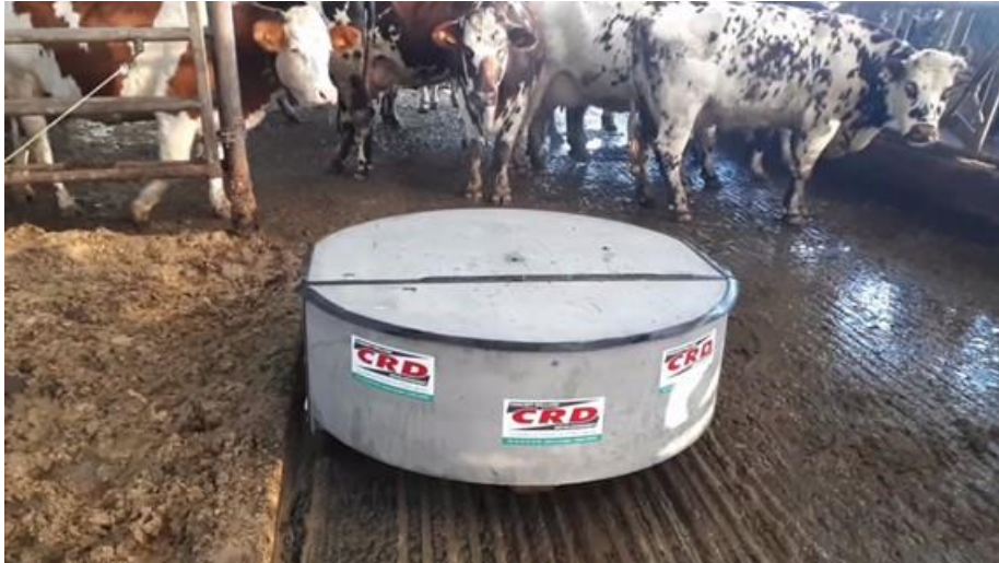
Slika 9: Robot za čišćenje blatnog hodnika na govedarskoj farmi (Izvor: Generationrobots.com)
