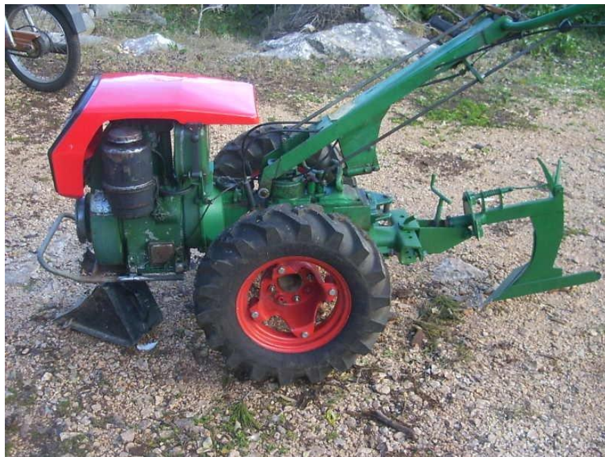
Slika 12. Motokultivator za obradu tla s nastavkom za oranje
