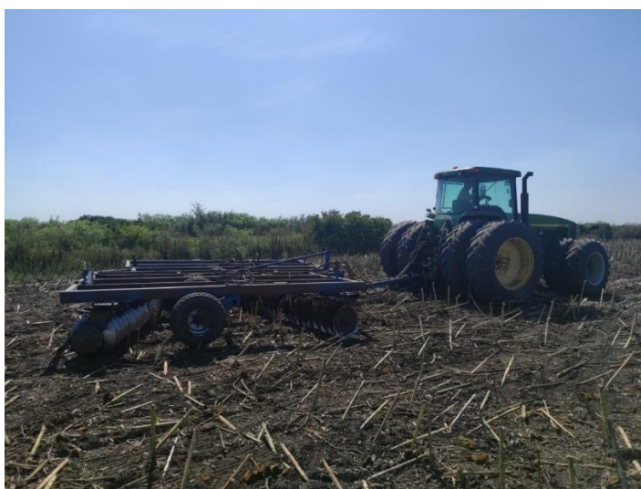
Slika 2. Teška tanjurača Neretva (5 m)
