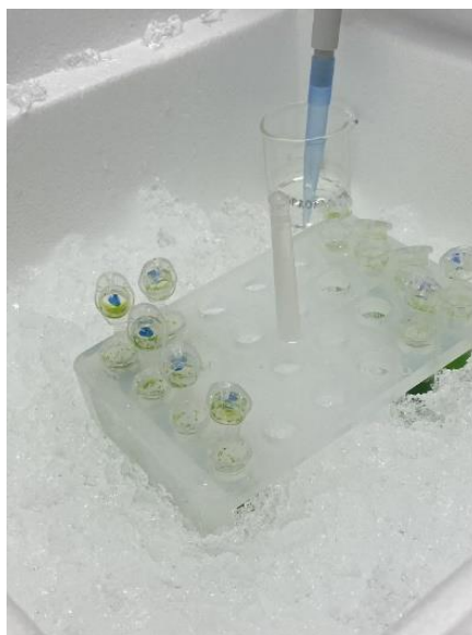
Slika 18. Dodavanje kloroform izomilnog alkohola u tubice (foto original: J. Kovač)
