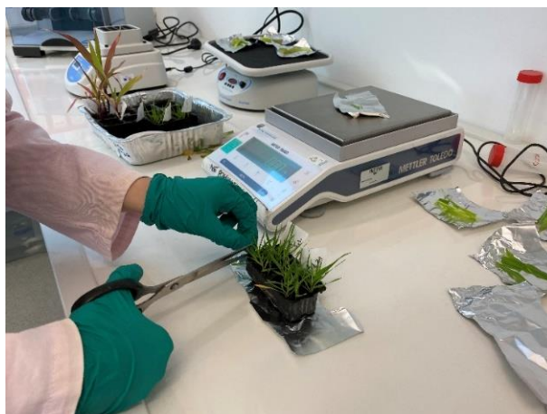
Slika 12. Rezanje i vaganje lisnog tkiva uzgojenih biljnih vrsta (foto original: J. Kovač)
