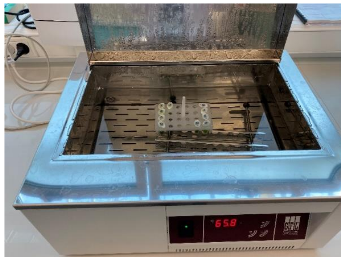
Slika 17. Inkubacija uzoraka u vodenoj kupelji (foto original: J. Kovač)
