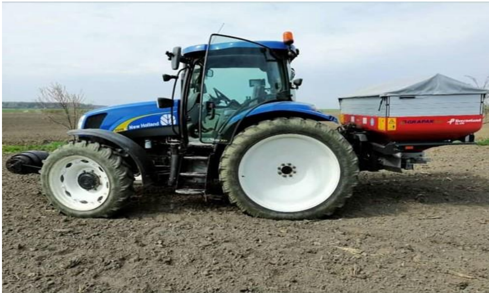
Slika 11. raspodjeljivač mineralnog gnojiva Kverneland Exacta CL-EW GEOSPREAD
