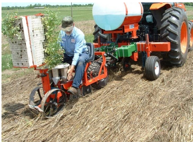
Slika 17. Strojno presađivanje presadnica s dopuštenjem Andy Zieminski (USDA-SARE)
