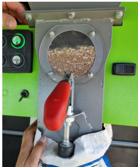
Slika 4. Vršenje uzoraka pšenice i ispuštanje u vreće (izvor: Marinić, M.)
