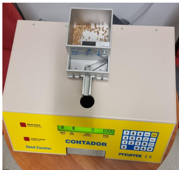
Slika 7. Brojanje 1000 zrna pomoću brojača zrna (izvor: Marinić, M.)
