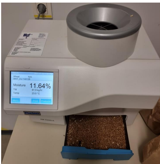
Slika 6. Mjerenje hektolitarske mase i vlage zrna (izvor: Marinić, M.)
