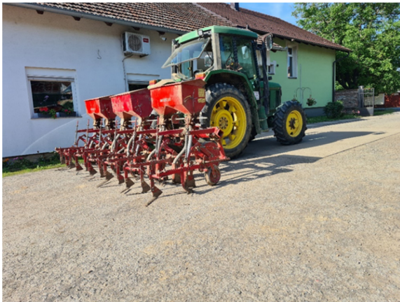
Slika 12. Kultivator IMT agregatiran za traktor John Deere 6310 (Izvor: Davor Blažević)
