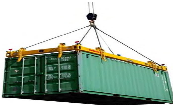
Slika 31. Uređaj za ukrcavanje i iskrcavanje kontejnera Top spreader Izvor: ( https://www.tandemloc.com/n3100-series )
