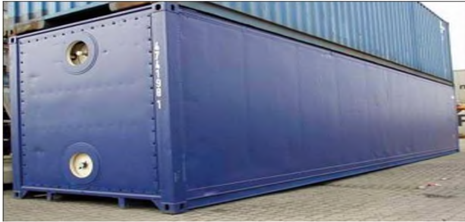
Slika 29. Rashladni izolacijski kontejner Izvor: (Piala i sur, 2016.)
