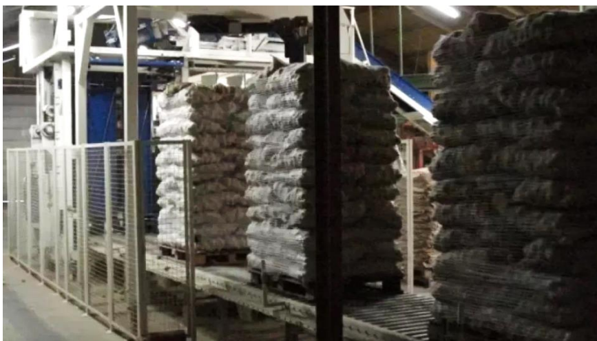
Slika 15. Paletizator vreća krumpira (Izvor: https://grapak.hr/proizvod/paletizator-symach )
