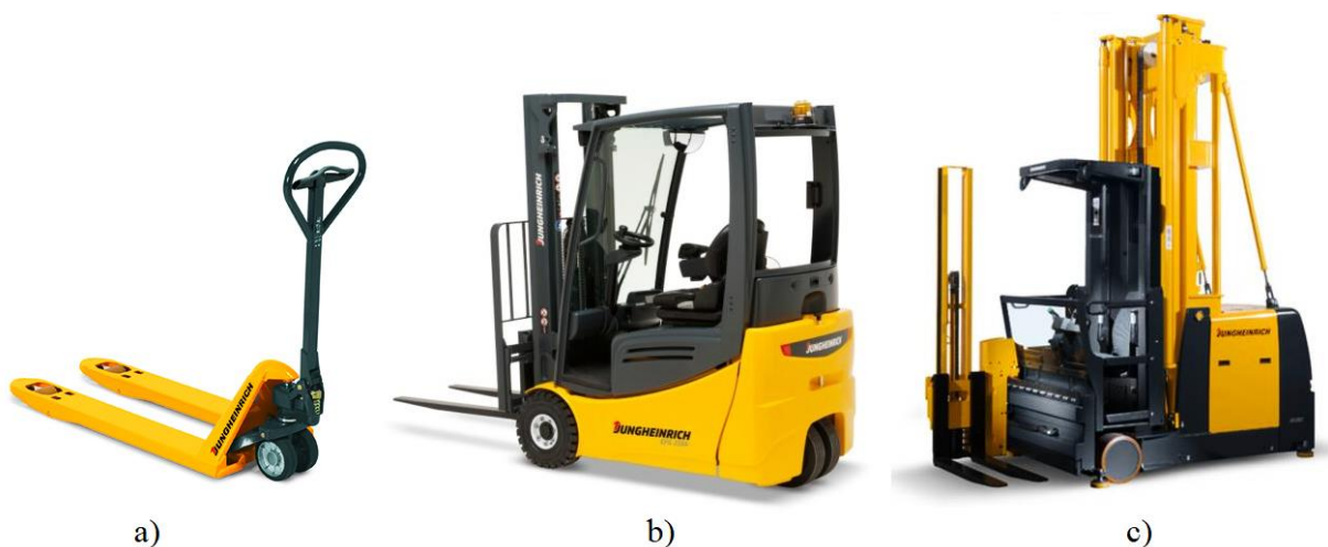
Slika 13. Primjeri paletnih viličara – ručni (a), čeonni (b) i visokoregalni (c)
