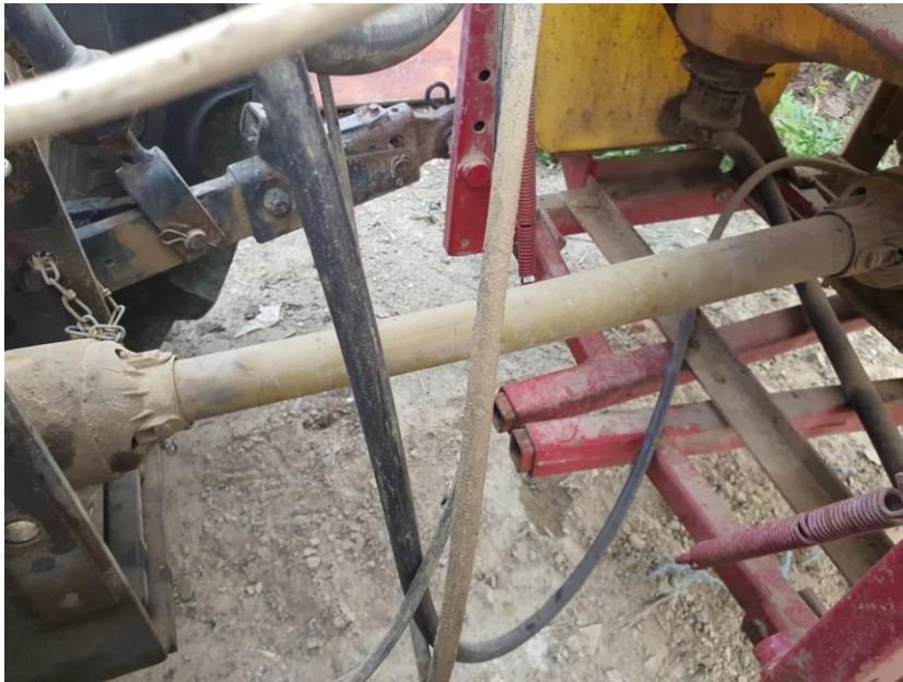
Slika 4. Priključno vratilo sa zaštitom
