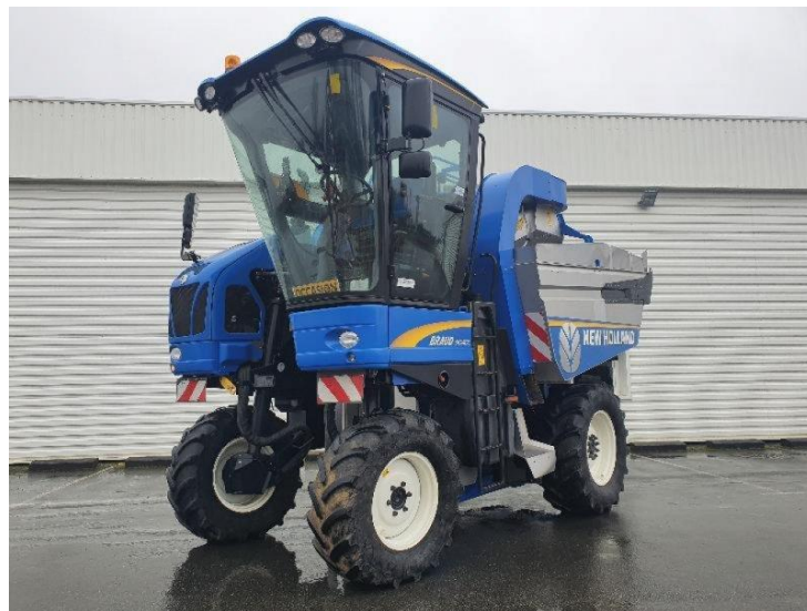
Slika 2. Samohodni kombajn za branje grožđa ( Braud )
