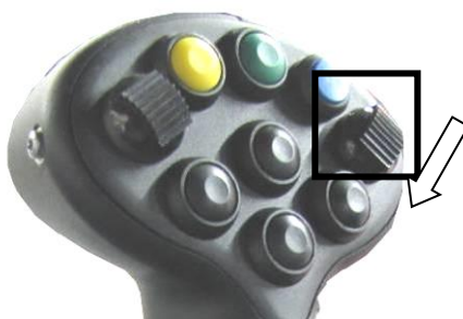
Slika 30. Prikaz tipke i smjera za vraćanje spremnika u početni položaj
