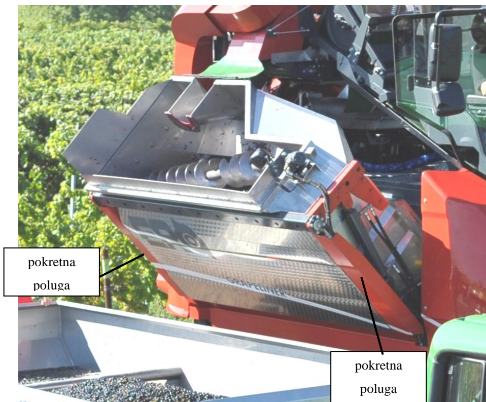
Slika 27. Prikaz pražnjenja spremnika za grožđe
