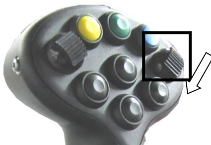
Slika 30. Prikaz tipke i smjera za vraćanje spremnika u početni položaj
