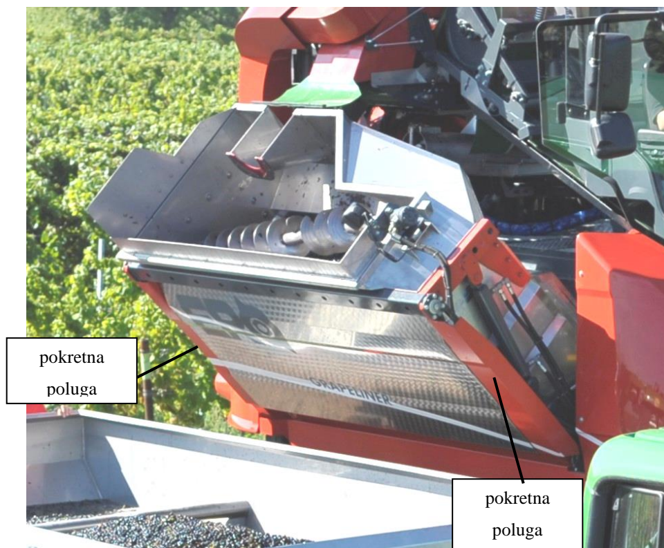
Slika 27. Prikaz pražnjenja spremnika za grožđe
