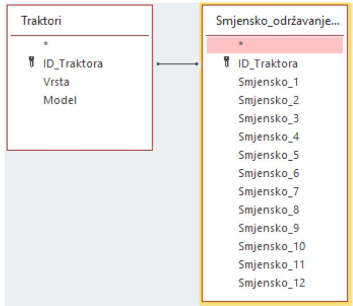
Slika 14. Prikaz odnosa između osnovnih *tablica* smjenskog održavanja traktora
