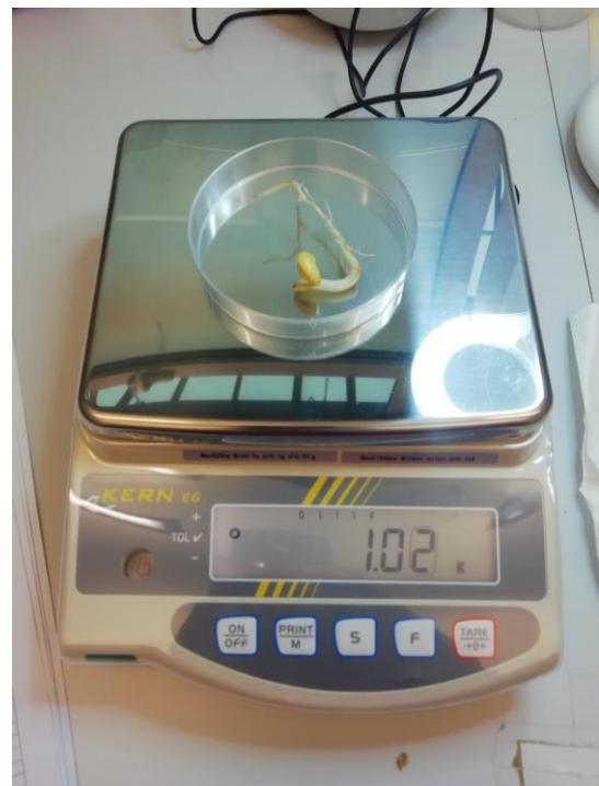
Slika 5. Određivanje mase klijanca soje nakon 8 dana na temperaturi 15°C (Tót, 2020.)
