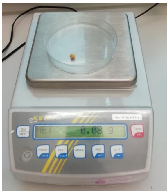
Slika 3. Određivanje mase pojedinačnih sjemenki soje (Tót, 2020.)
