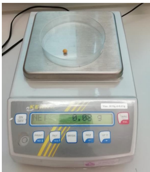
Slika 3. Određivanje mase pojedinačnih sjemenki soje (Tót, 2020.)
