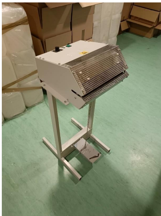
Slika 7. Varilica za varenje vrećica (Izvor: I. Rastija)
