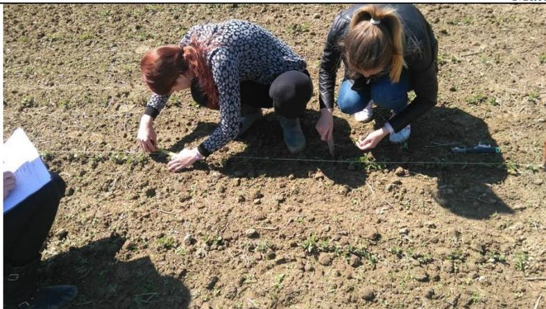
Slika 2.22. Poprečna raspodjela sjemena (izvor: vlastita fotografija)
