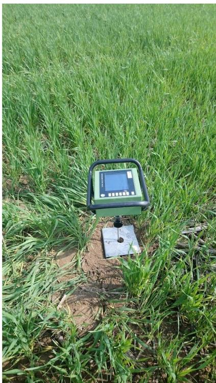
Slika 2.34. Utvrđivanje zbijenosti tla penetrometrom (izvor: vlastita fotografija)
