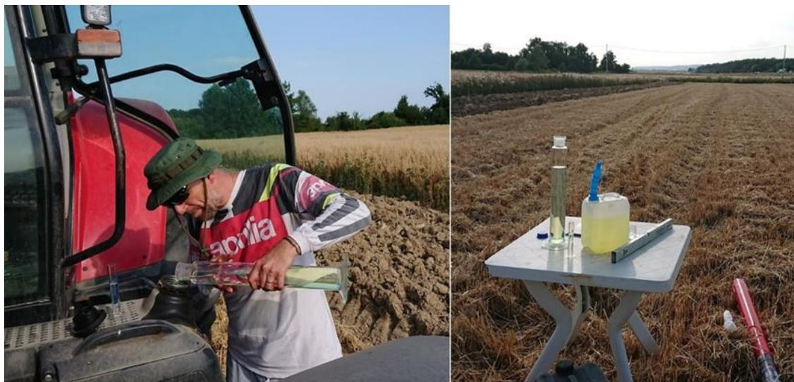
Slika 2.13. Ispitivanje točnosti rada putnog računala (izvor: vlastita fotografija)
