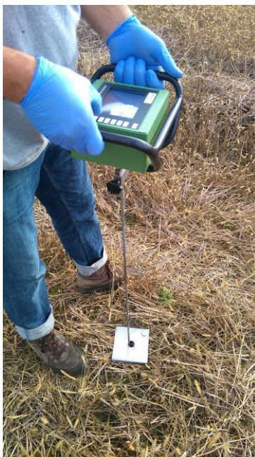
Slika. 2.15. Penetrometiranje (izvor: vlastita fotografija)
