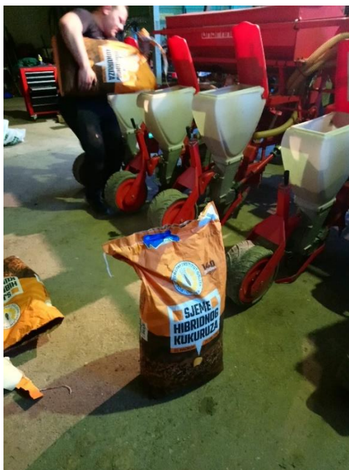
Slika 2.27. Pneumatska sijačica Gaspardo DORADA SP6 (izvor: vlastita fotografija)
