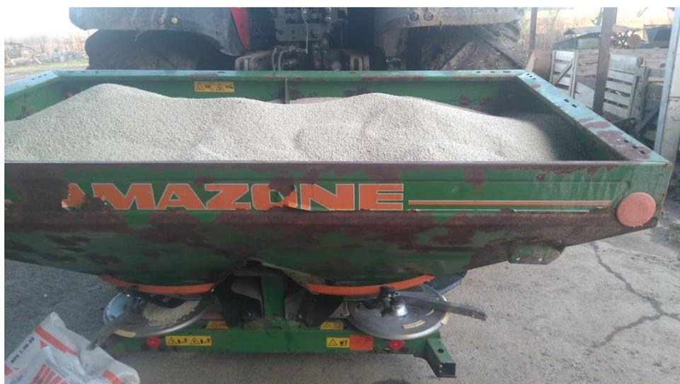
Slika 2.10. Rasipač mineralnog gnojiva *Amazone ZA-M 1200* (izvor: vlastita fotografija)
