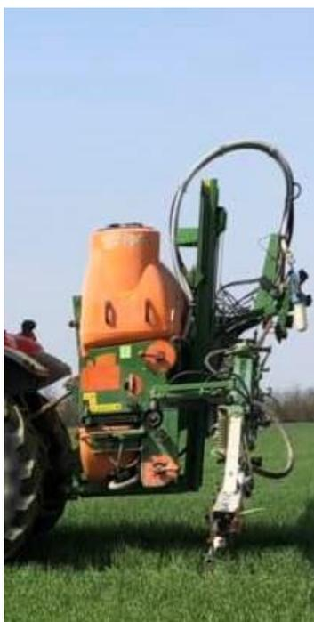
Slika 2.11. Nošena prskalica *Amazone UF 1501* (izvor: vlastita fotografija)Tablica 2.11. Tehničke karakteristike prskalice *Amazone UF 1501*
