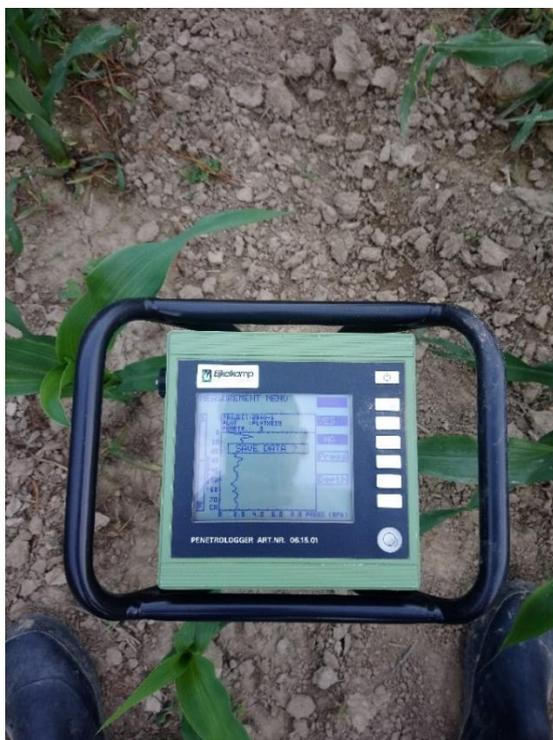
Slika 2.12. Penetrometar "Eijkelkamp Penetrologger SN" (izvor: vlastita fotografija)
