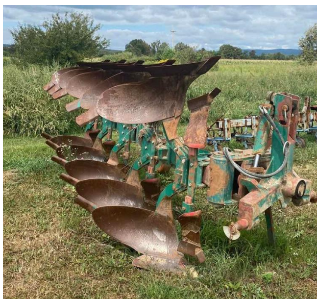
Slika 2.3. Regent Titan 15 peterobrazdni plug (izvor: vlastita fotografija)
