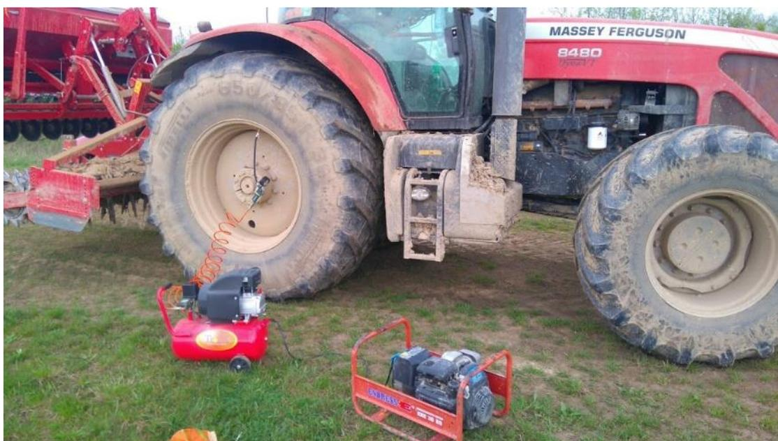
Slika 2.8. Podešavanje tlakova pneumatika (izvor: vlastita fotografija)
