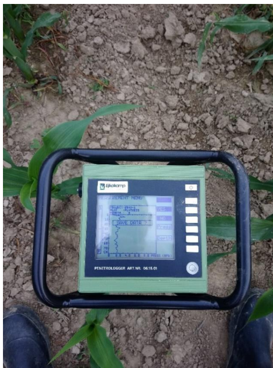
Slika 2.12. Penetrometar "Eijkelkamp Penetrologger SN" (izvor: vlastita fotografija)
