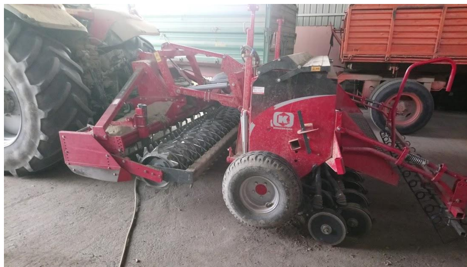
Slika 2.21. Sijačica Kongskilde PROFILINE DR23 (izvor: vlastita fotografija)
