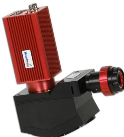
Slika 18. Hyperspec Ext-VNIR hiperspektralni senzor
