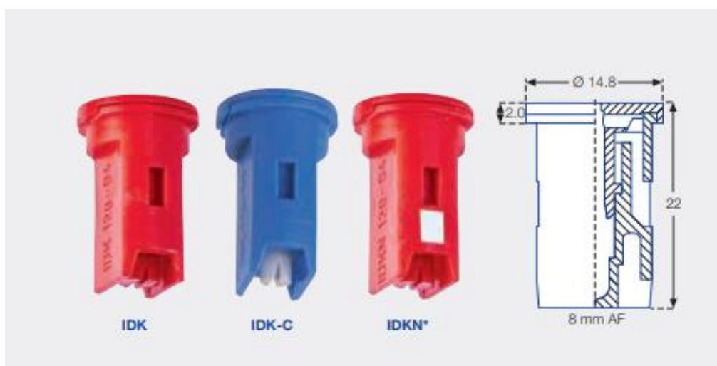
Slika 8. Oblik i izvedba tijela injektorske mlaznice lepezastoga mlaza tvrtke „Lechler“ IDK, IDK-C i IDKN
