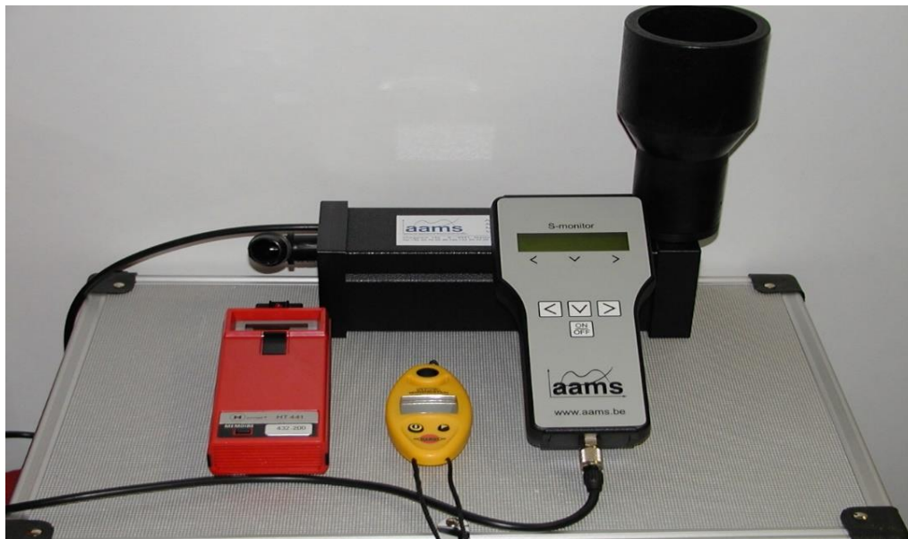
Slika 3. Uređaj za mjerenje protoka pojedinačnih mlaznica
