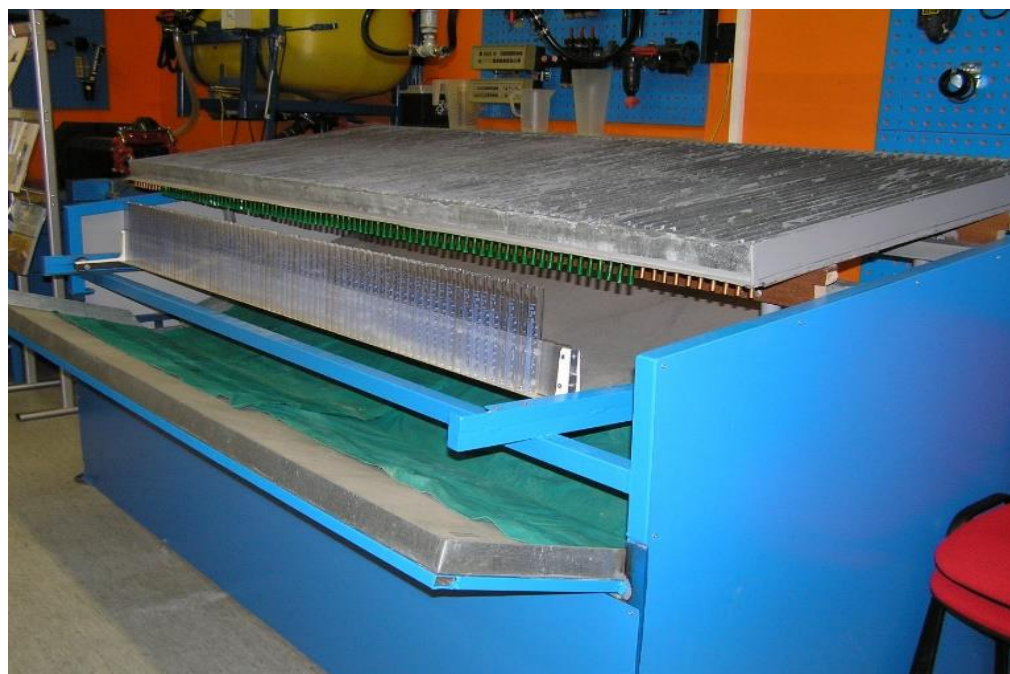
Slika 4. Ispitni stol za utvrđivanje površinske raspodjele tekućine mlaznica u Zavodu za poljoprivrednu tehniku i obnovljive izvore energije (Izvor: Toma, 2022.)
