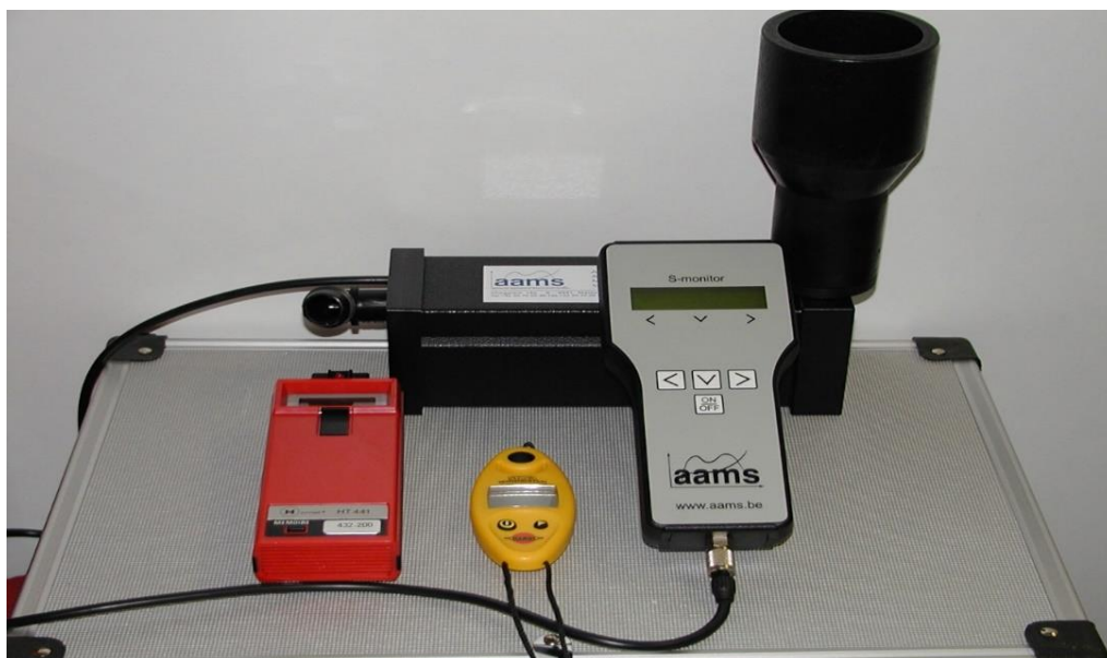
Slika 3. Uređaj za mjerenje protoka pojedinačnih mlaznica (Izvor: Toma, 2022. )
