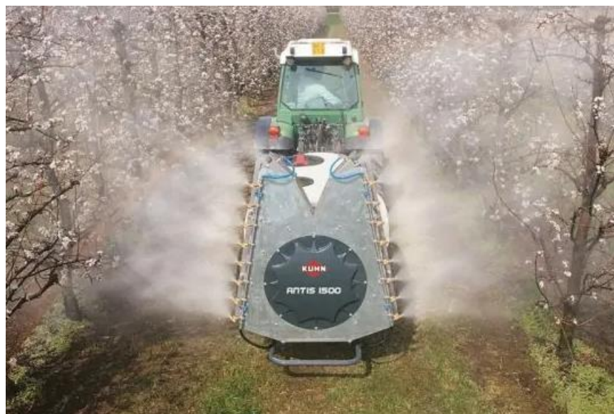
Slika 16. Raspršivač sa zračno – injektorskom mlaznicama
