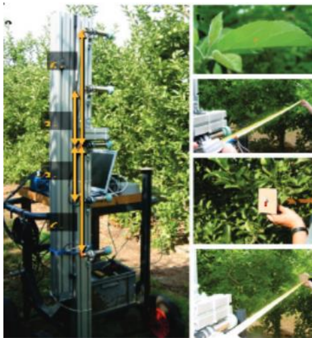
Slika 3. Ispitna platforma s ultrazvučnim sensorima
