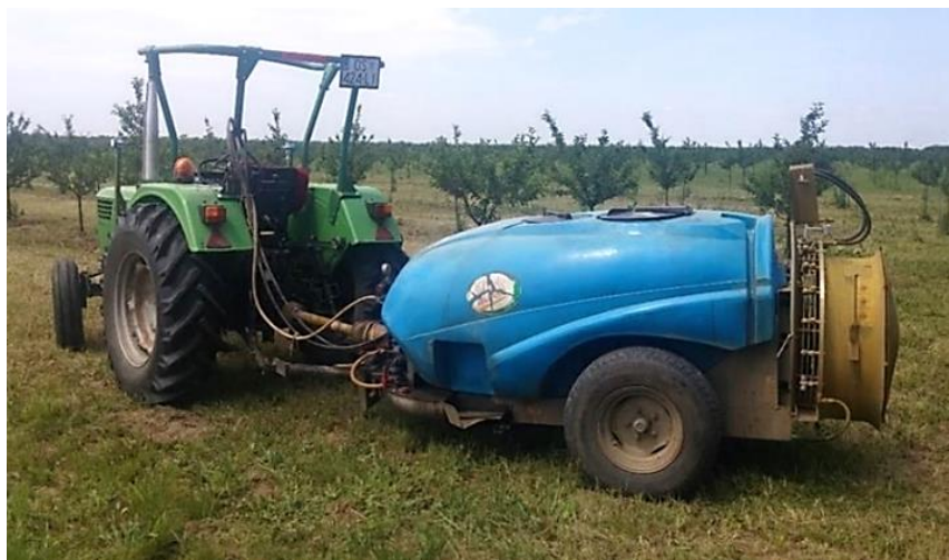
Slika 6. Vučeni raspršivač Tifone Vento 1500
