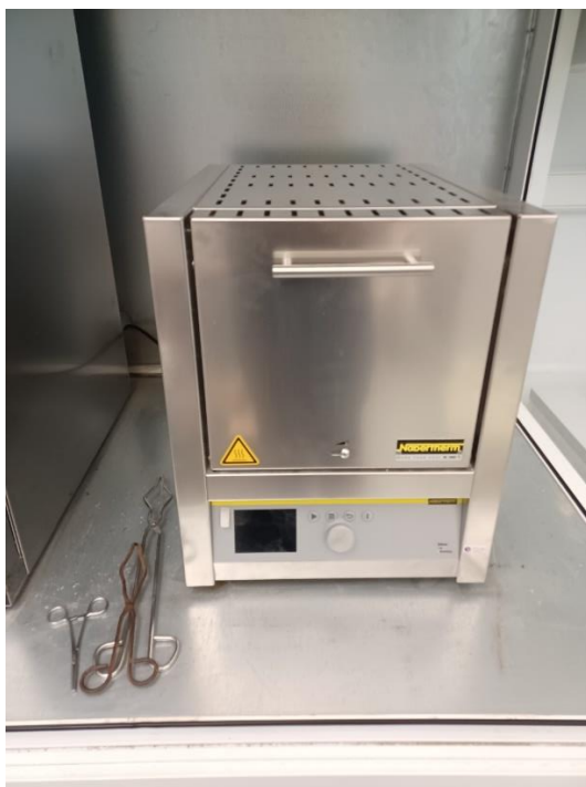
Slika 9. Mufolna peć (Izvor: Autor)
