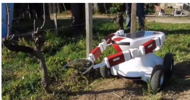
Slika 4: robot za rezidbu vinove loze
