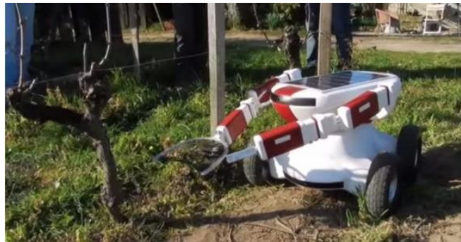
Slika 4: robot za rezidbu vinove loze
