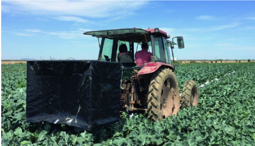
Slika 17. Kutija sa senzorom za prikupljanje podataka (Izvor: Montes, H. A. i sur., 2021.)
