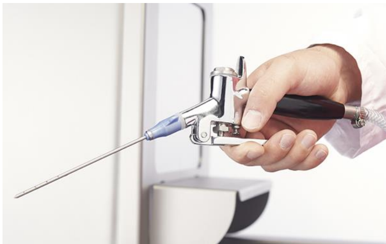
Slika 12. Ručni injektor za ubrizgavanje salamure u meso
