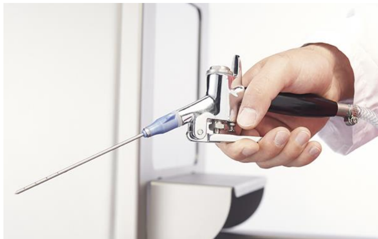
Slika 12. Ručni injektor za ubrizgavanje salamure u meso
