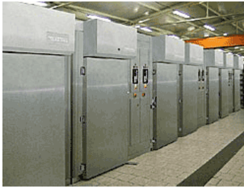
Slika 14. Komore za dimljenje šunki u velikim industrijama
