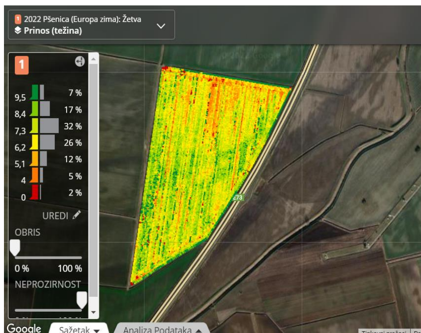
Slika 30. Karta prinosa ( Yield mapping ) izrađena pomoću kombajna (Izvor:PPK Valpovo)
