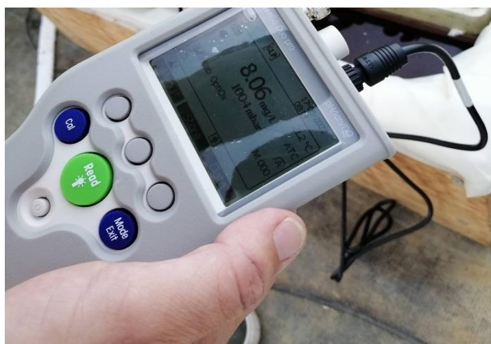
Slika 6. Mjerenje koncentracije otopljenog kisika u hranjivoj otopini (Foto: B. Ravnjak)
