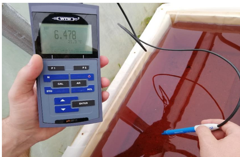
Slika 5. Mjerenje pH vrijednosti u hranjivoj otopini (Foto: B. Ravnjak)
