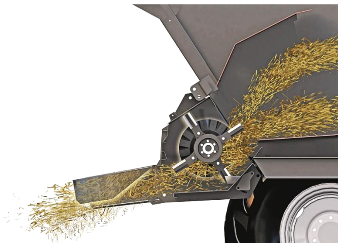
Slika 17. Uređaj za obradu žetvenih ostataka (Izvor: Korbanek, 2019.)
