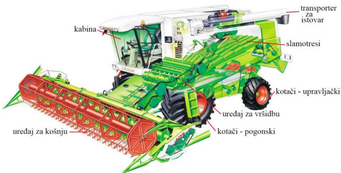
Slika 12. Glavni radni sklopovi žitnog kombajna (Izvor: Makar, 2015.)
