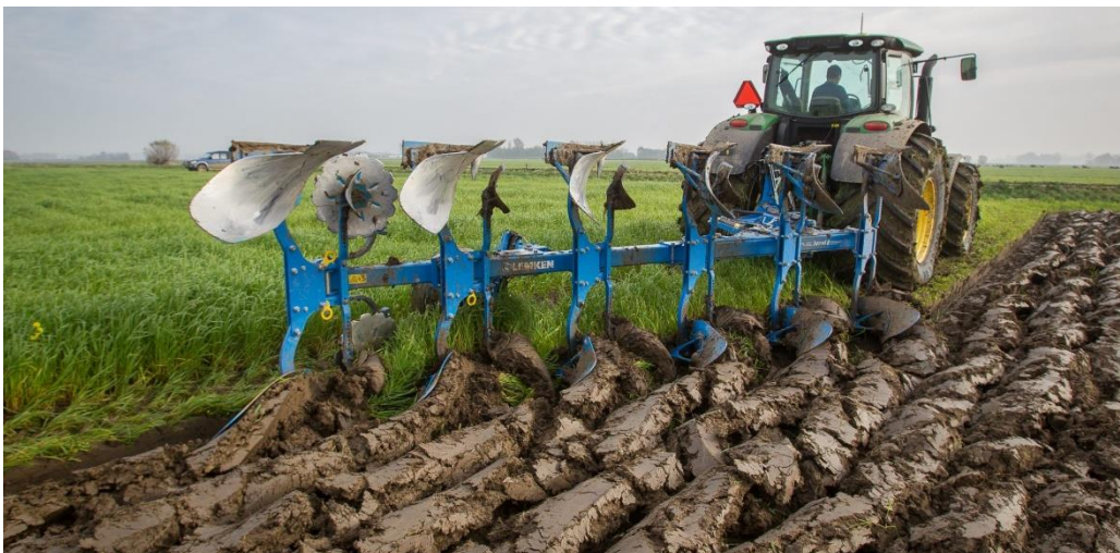
Slika 2. Konvencionalna obrada tla plugom
