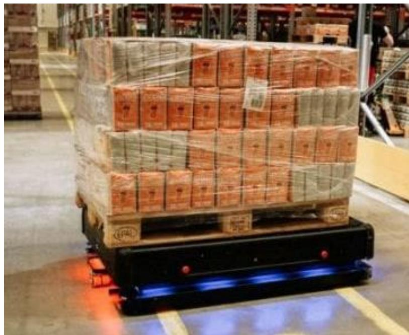
Slika 12. Prenošenje palete korištenjem autonomnih mobilnih robota
