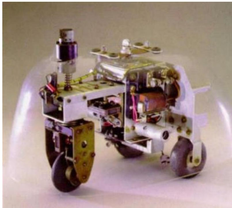
Slika 7. Machine Speculatrix - prvi tip robota
