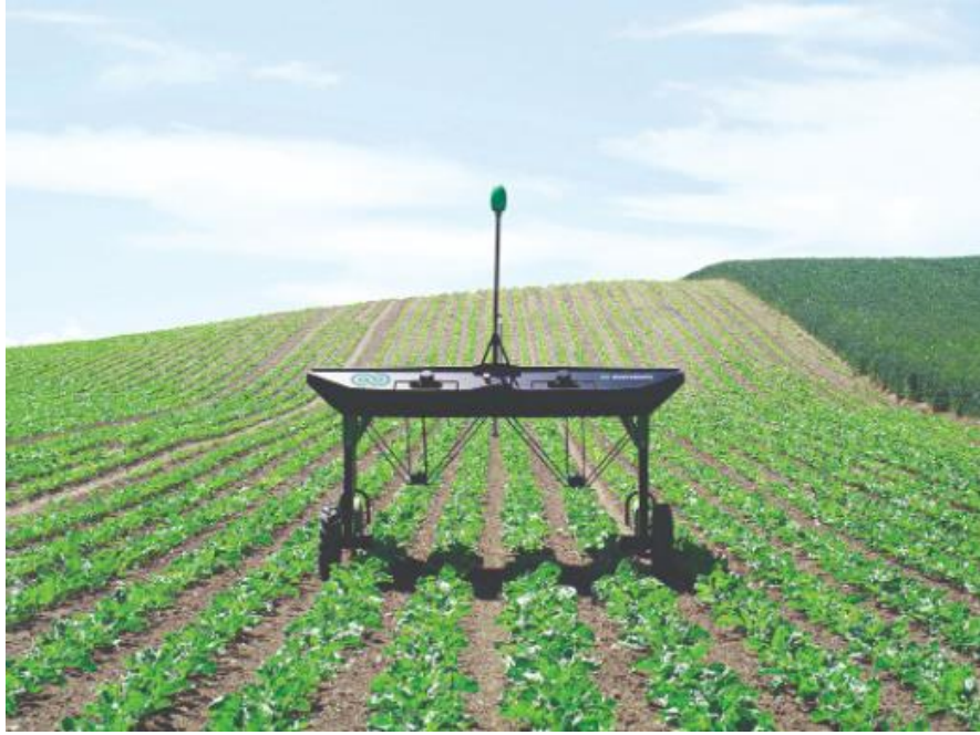
Slika 6. Poljoprivredni robot za kultivaciju
