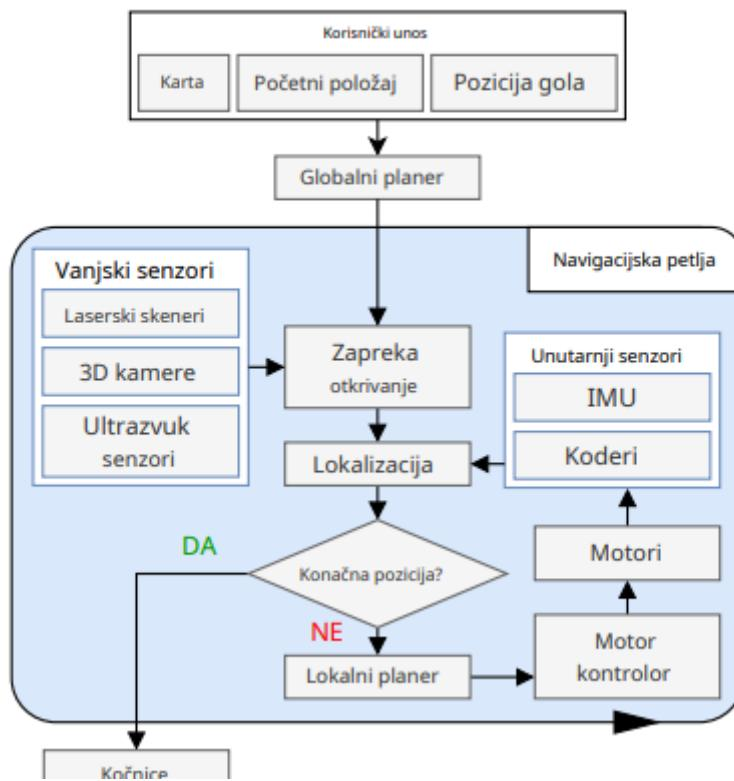
Slika 17. Princip rada navigacije autonomnih mobilnih robota
