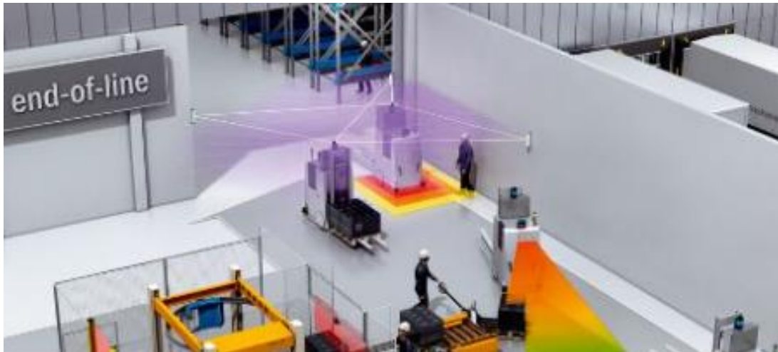
Slika 19. Navigacija u skladištu s navigacijskim skenerima LiDAR
