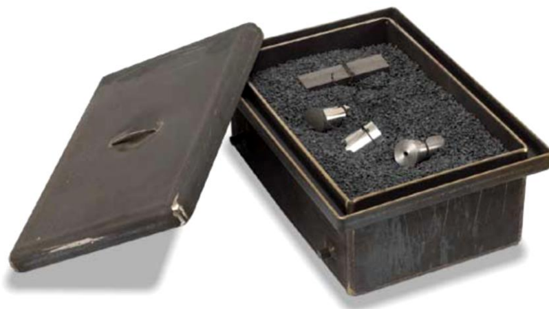
Slika 9. Kutija za boriranje s proizvodima u granulatu (Izvor: Nabertherm, 2007.)
