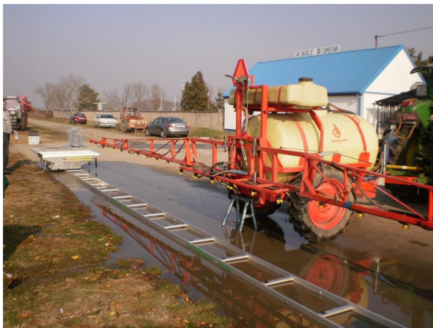
Slika 13. Ispitivanje horizontalne raspodjele - spray scanner
