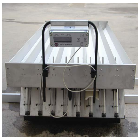
Slika 12. Uređaj za ispitivanje horizontalne raspodjele tekućine – spray scanner
