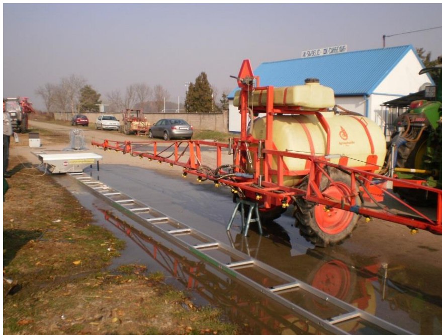
Slika 13. Ispitivanje horizontalne raspodjele - spray scanner
