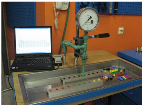
Slika 11. Stolno – elektronski uređaj za mjerenje protoka mlaznica (lijevo) i uređaj za mjerenje protoka AAMS (desno)
