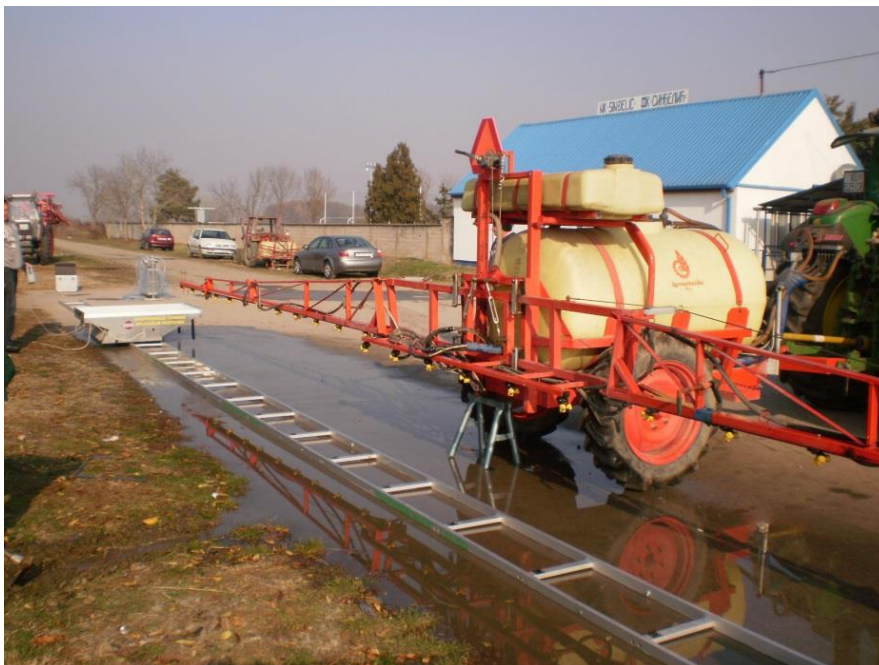
Slika 13. Ispitivanje horizontalne raspodjele - spray scanner
