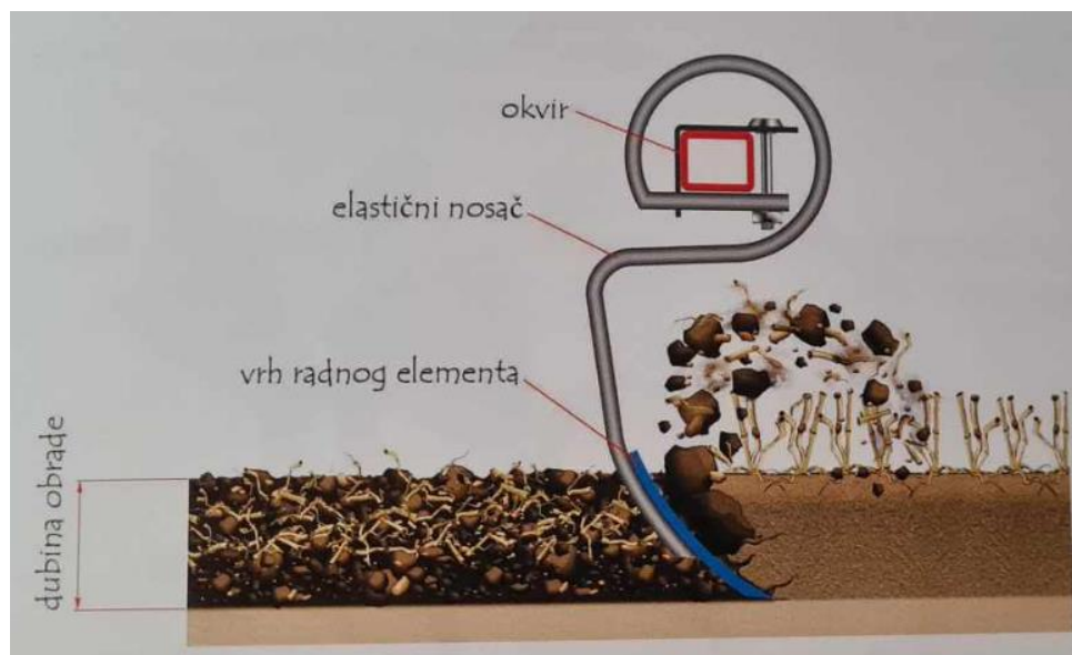
Slika 8. Shematski prikaz rada rovila (Izvor: Kušec i Sito, 2019)
