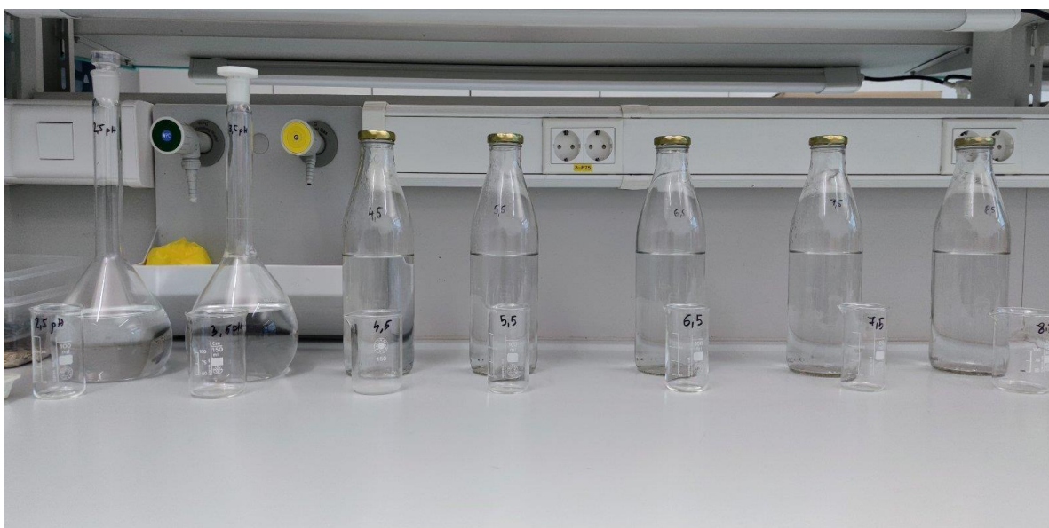
Slika 2. Pripremljene otopine različite pH vrijednosti (Varga, 2023.)
